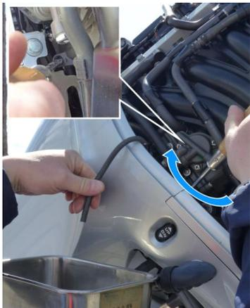
6. Dopo aver scaricato, avvitare la vite di scarico.
