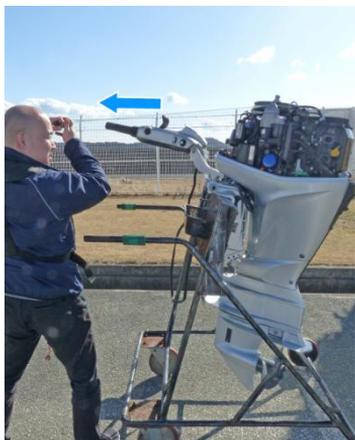
15. Rimuovere il coperchio del rotore ACG. Avvolgere la fune dell'avviatore di emergenza (vedere la procedura di avviamento di emergenza). Scaricare l'acqua dal cilindro tirando la fune dell'avviatore di emergenza diverse volte.
