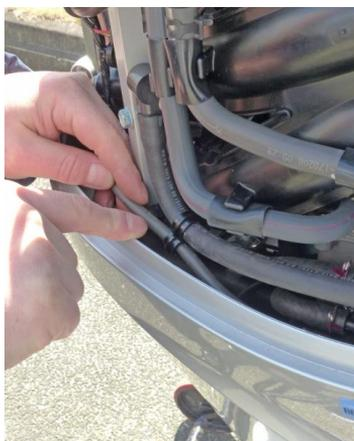
7. Fissare il condotto di scarico alla sporgenza del collettore di aspirazione.
