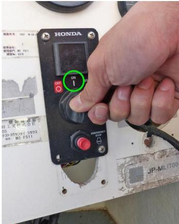
10. Girare l'interruttore motore in posizione ON.
