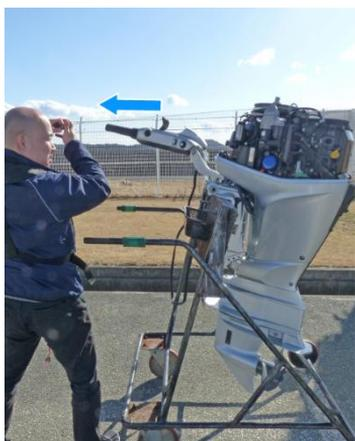
17. Tirare la fune dell'avviatore di emergenza diverse volte per lubrificare l'interno del cilindro. Quindi rimuovere la fune dell'avviatore di emergenza.
