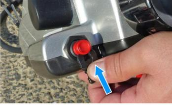
9. Inserire il fermaglio nell'interruttore di arresto di emergenza. Fissare saldamente l'altra estremità del cordino dell'interruttore di arresto di emergenza all'operatore.
