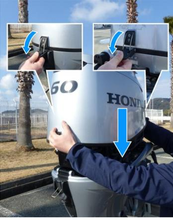
14. Rimuovere il coperchio del rotore ACG e installare il coprimotore. Bloccare i dispositivi di fissaggio del coprimotore.
