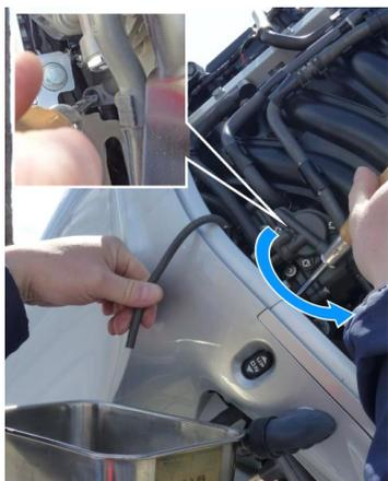
3. Sganciare il condotto di scarico dalla sporgenza del collettore di aspirazione, quindi far uscire l'estremità del condotto di scarico da sotto il coperchio.
