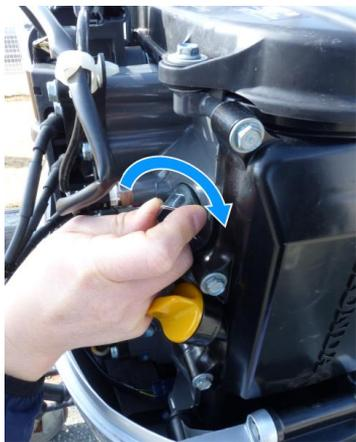
18. Installare manualmente e con attenzione le candele per evitare di incrociare le filettature. Dopo avere montato la candela serrare di 1/8—1/4 di giro. Installare il coperchio del rotore ACG.
