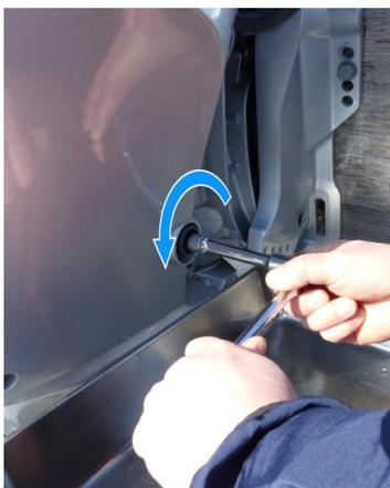
10. Posizionare un contenitore adatto sotto la guida per lo scarico dell'olio, rimuovere il bullone di scarico dell'olio motore e la rondella. Scaricare l'olio motore fino a quando il flusso dell'olio vecchio non si riduce a un gocciolio.
